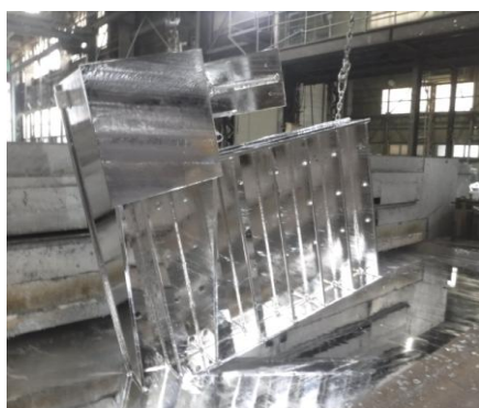
タナカ-AZ の適用製品例（落橋防止ブラケット：左はめっき状況・右は設置状況）
